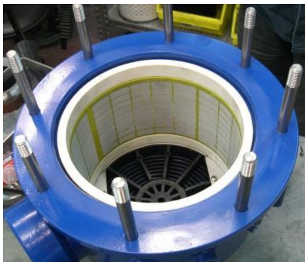
La malla asentada en forma adecuada
